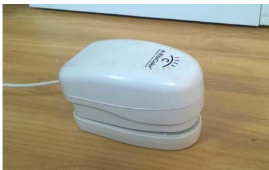
Рис. 1. – Спектрофотометр DTP22 X-Rite Color Digital Swatchbook и его схема
