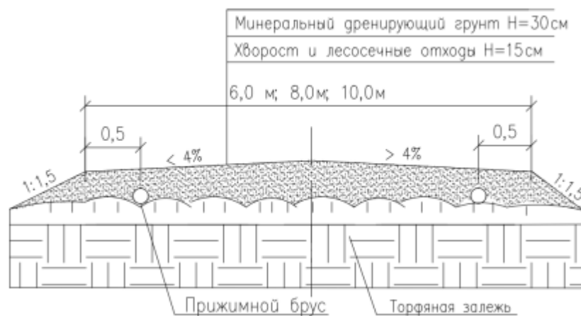
Рис. 2. – Лежневая дорога с основанием из хворостяной выстилки.
