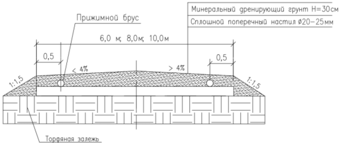
Рис. 1. – Лежневая дорога с основанием из бревен
