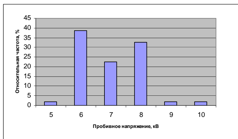
Рис. 3. – Гистограмма распределения значений пробивного напряжения на свече зажигания ДВС
