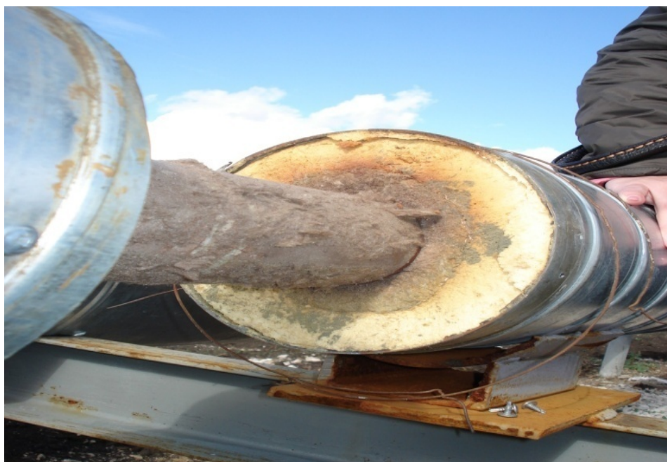
Рис. 2. – Торец двухслойной тепловой изоляции (базальт + пенополиуретан)
