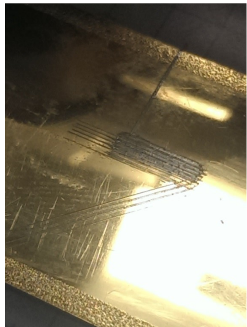
Рис. 4. — Глубокие царапины на поверхности заготовки из тонкой и «мягкой» заготовки из латуни
