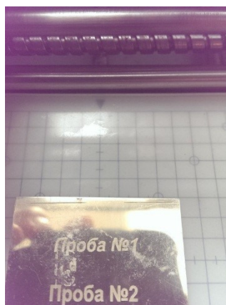
Рис. 5. – Искажение текста на поверхности заготовки из твердого сплава латуни
