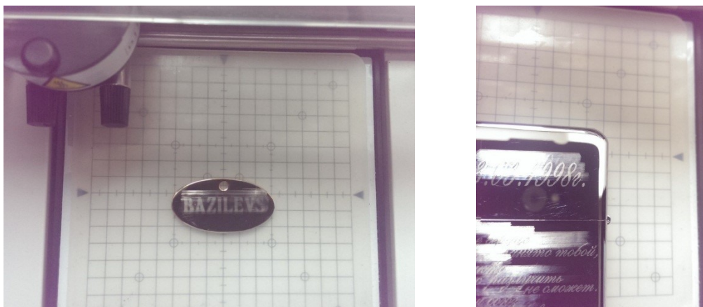
Рис. 3. — Тень на поверхности надписи заготовки из латуни.
