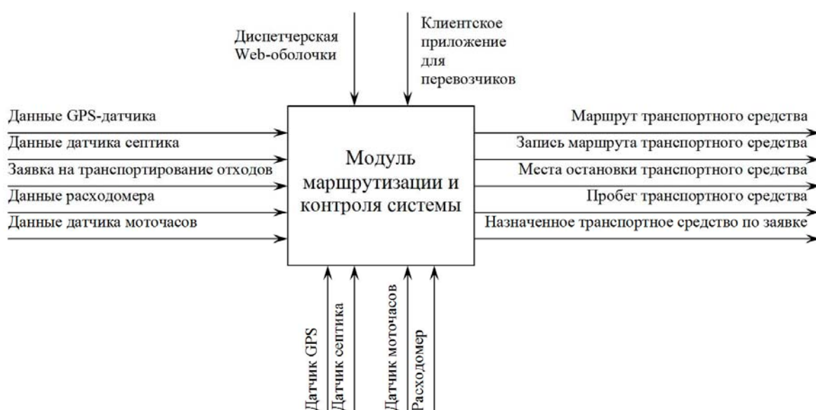
Рис. 9. – Схема входных и выходных данных модуля маршрутизации
