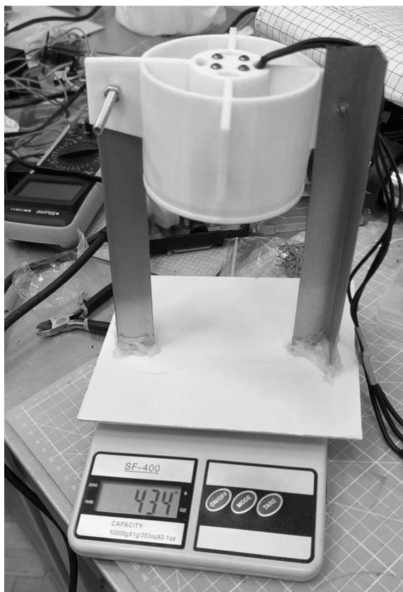
Рис. 5. – Лабораторный стенд для проведения испытани модели
