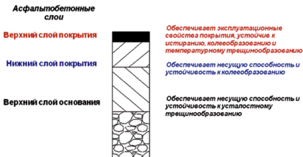
Рис. 3. – Функциональное конструирование пакета асфальтобетонных слоев [8]
