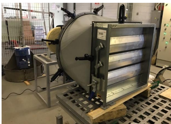
Рисунок 5. – Установка испытуемого клапана на стенд
