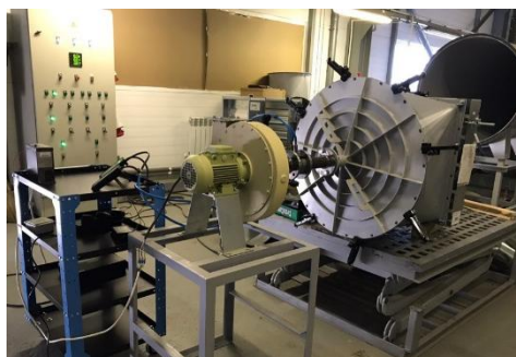
Рисунок 4. – Лабораторный стенд для испытания клапана на герметичность
