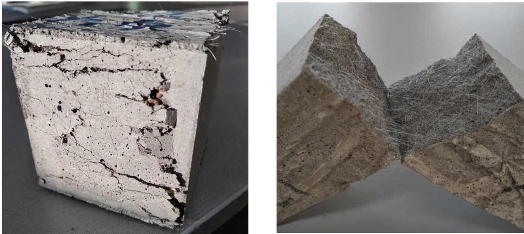
Рис. 3. – Характер разрушения фибробетона с полиамидной фиброй после испытания на сжатие и изгиб
