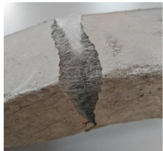
Рисунок 2 – Характер разрушения фибробетона с полипропиленовой фиброй после испытания на сжатие и изгиб
