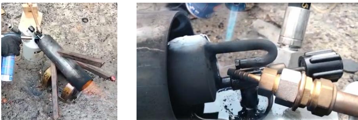
Рис. 2. – Схема дополнительного парового диспергирования ДТ (справа) для эффективного распыливания в условиях предварительных испытаний макетной установки (слева – общий вид).
