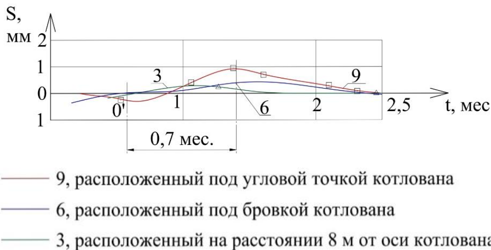
Рис. 3. Перемещения измерительных элементов, расположенных на глубине 8 метров от дневной поверхности котлована (0'- начало разработки котлована)
