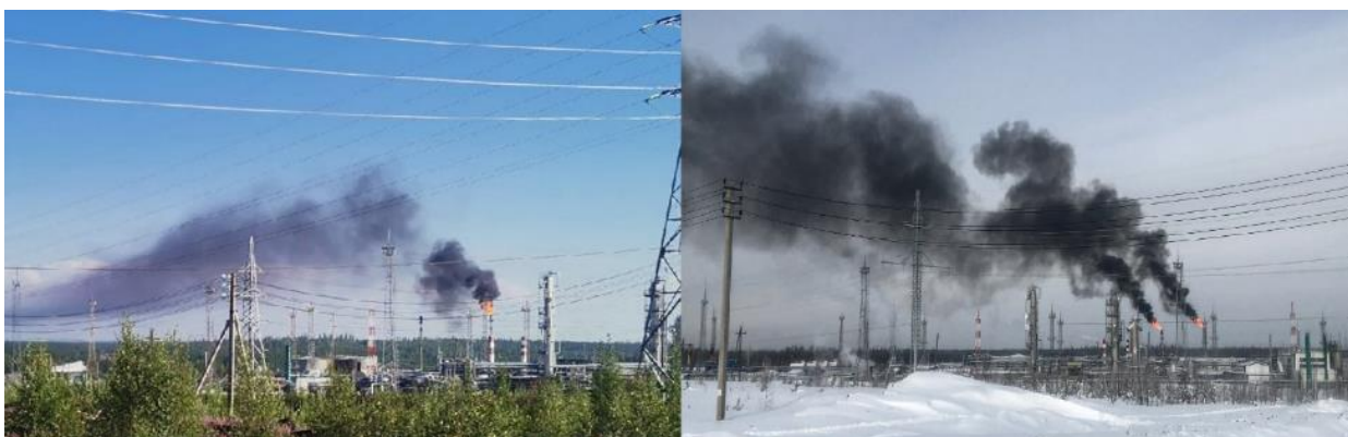
Рис.3. – Слева - факельный шлейф при температуре +25 С°; справа - факельный шлейф при температуре -30 С°.
