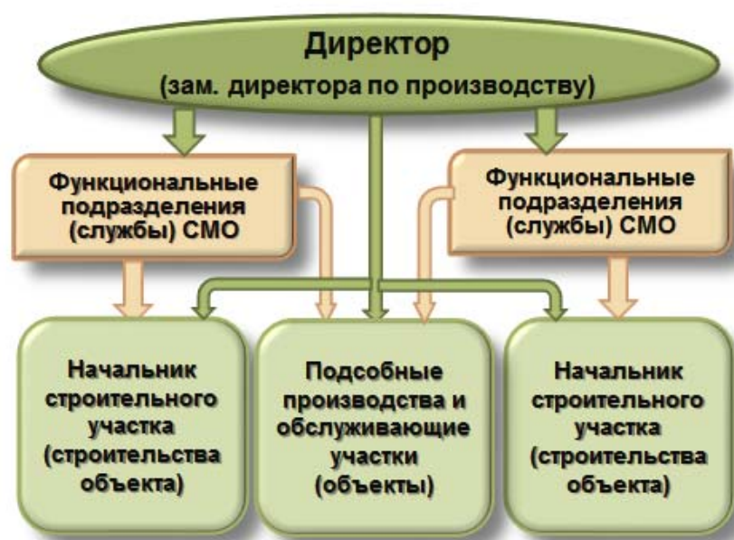
Рис. 2. - Функциональная структура управления строительным производством
