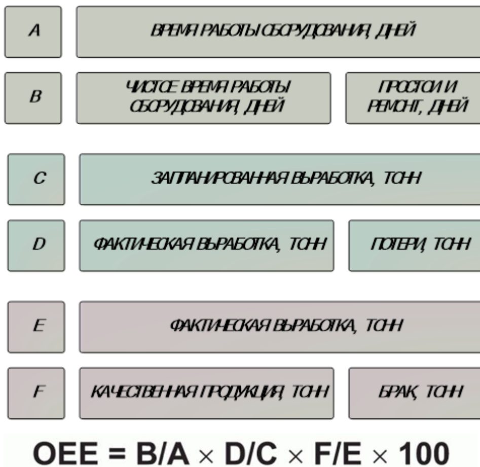
Рис. 2. – Расчет индекса OEE (Общей эффективности оборудования)
