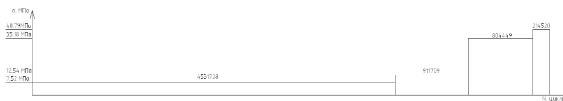
Рис. 9. – Спектр размаха местных напряжений 1962-1983 гг.
