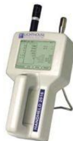
Рис. 1. – Счетчик частиц аэрозолей HANDHELD-3016
