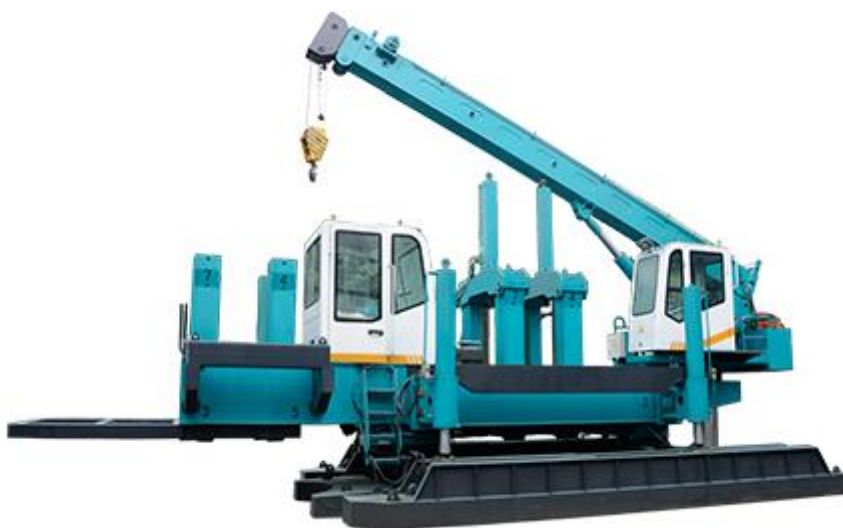
Рис. 1. – Установка вдавливания свай, оснащенная двумя вдавливающими узлами и крановым оборудованием
