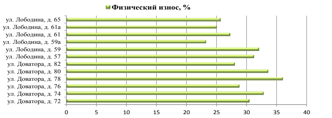
Рис. 1 - Физический износ жилых зданий
