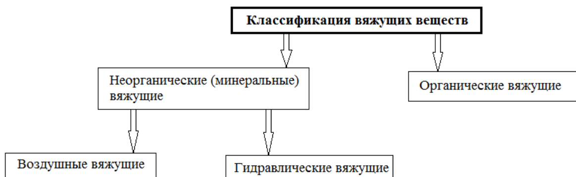
Рис. 7. – Схема классификации вяжущих материалов
