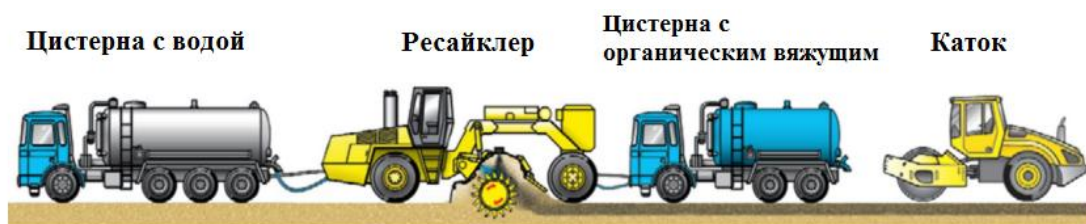
Рис. 9. – Схема производства работ при использовании органических вяжущих
