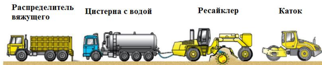
Рис. 8. – Схема производства работ при использовании неорганических вяжущих
