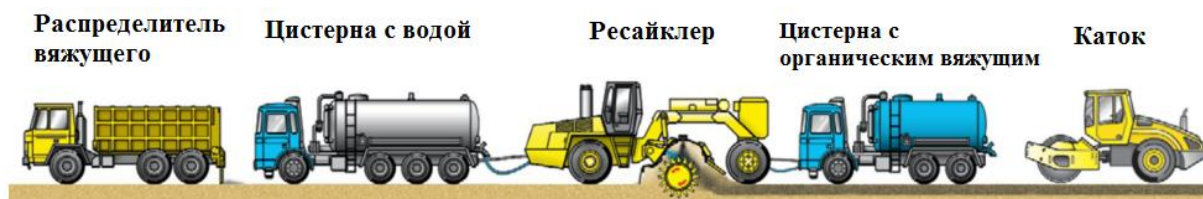
Рис. 9. – Схема производства работ при использовании органических вяжущих
