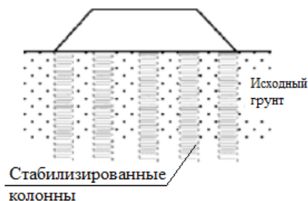
Рис. 3. – Схема стабилизации колоннами (СТО СРО 083-029ЕН-2011Разработка и реализация методов стабилизации слабых грунтов органического происхождения. Часть 2. Руководство по проектно-конструкторским работам: Стабилизация слабых грунтов)
