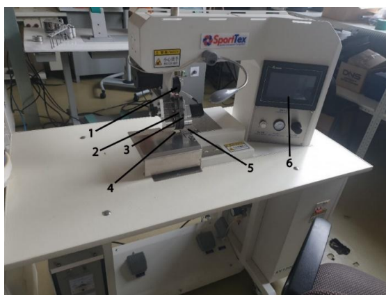
Рис. 1. - Общий вид машины KV1300-600С: 1 – направляющий ролик, 2 – нагревательный элемент, 3 – регулируемая под разную ширину ленты направляющая, 4 – прокатный транспортирующий ролик, 5 – ультразвуковой нож, 6 – панель управления
