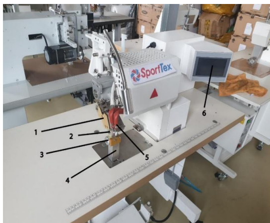
Рис. 3. – Общий вид машины HF – 702-02: 1 – нагревательный элемент с теплопроводящим ремнем, 2 – прижимной транспортирующий ролик, 3 - транспортирующий ролик, 4 - рабочая колонка, 5 – сопла подачи горячего воздуха, 6 – панель управления
