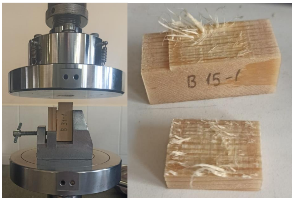
Рис. 2. Испытание образцов и характер их разрушений
