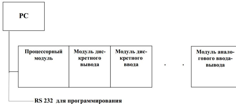
Рис. 3. – Типовая конфигурация контроллера [3]: программируемый контроллер – programmable controller (PC); проводной дуплексный интерфейс – Recommended Standard 232 (RS 232)
