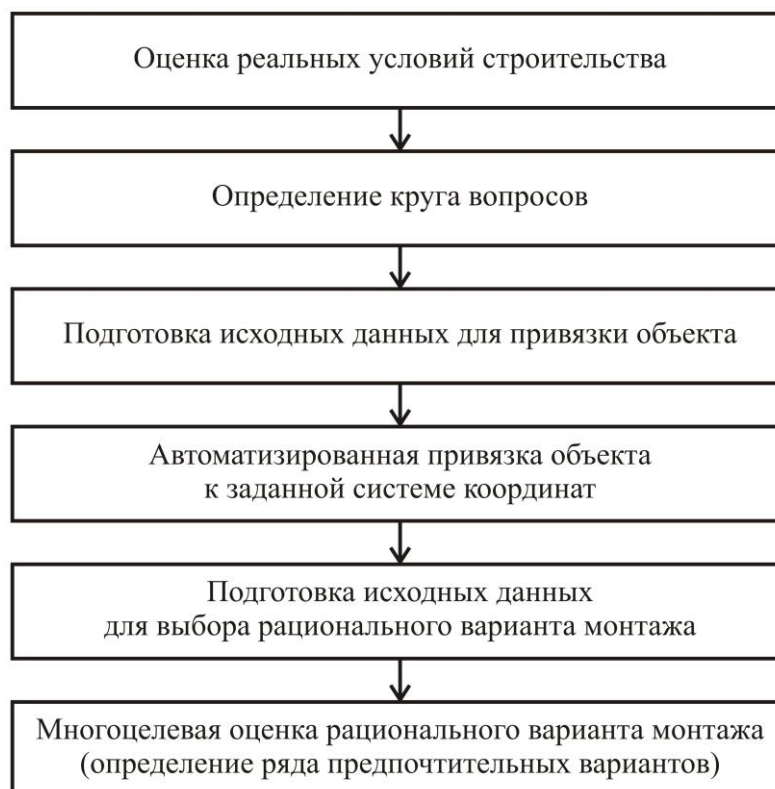
Рис. 2. – Алгоритм действий эксперта при решении задач по оценке вариантов проектных решений монтажа спецсооружений
