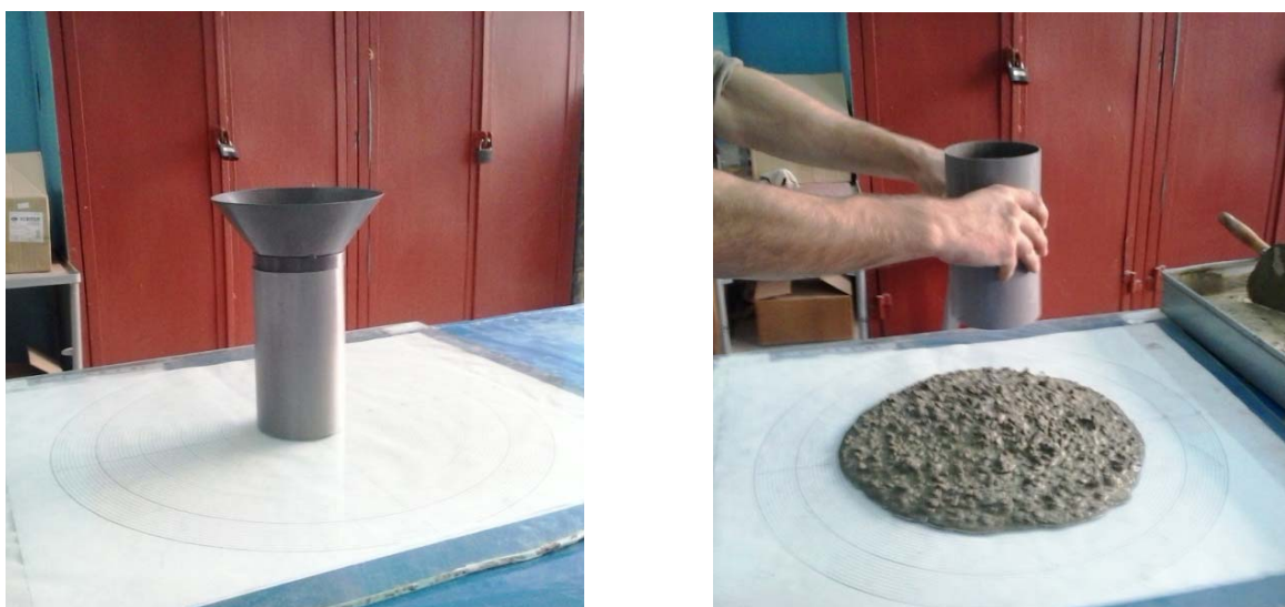
Рис. 2. – Прибор для определения предельного напряжения сдвига смеси
