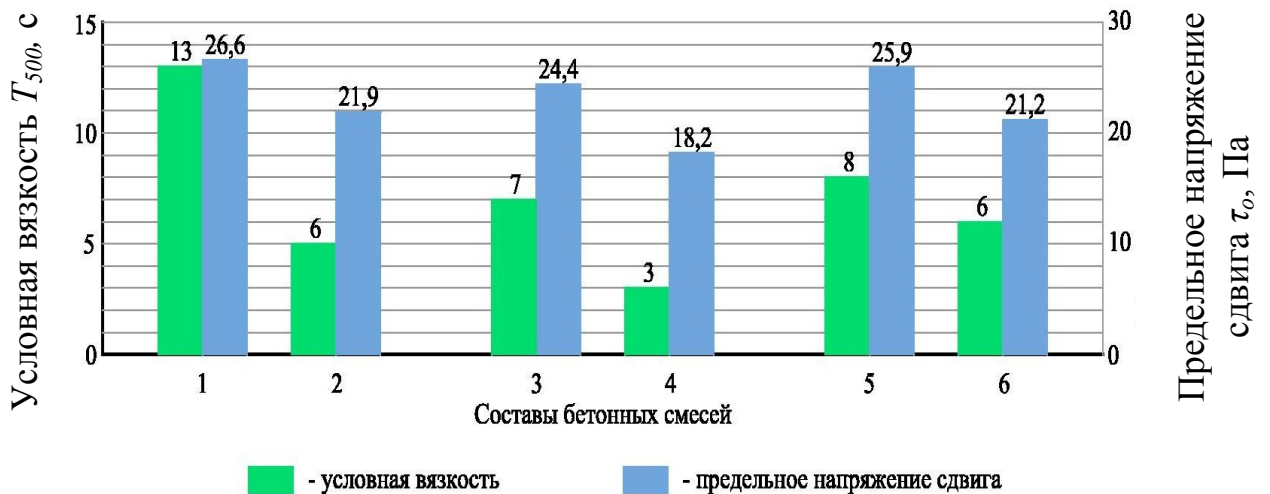
Рис.4. – Изменение условной вязкости и предельных напряжений сдвига бетонных смесей составов 1 – 6
