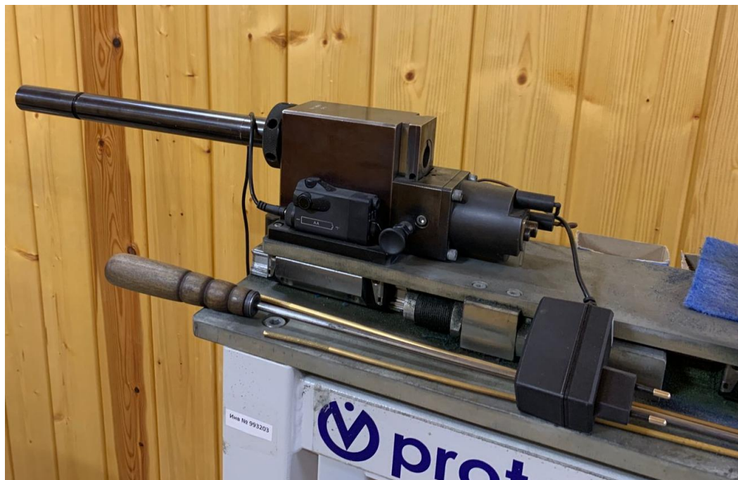
Рис. 1 Имитатор осколка. Баллистический ствол без нарезов – «Прототипа UZ-2011»
